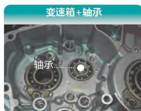
轴承损坏(寿命)、振动、噪声
