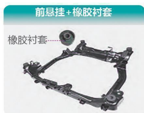
橡胶衬套损坏/破裂 由于不对准造成的过载
